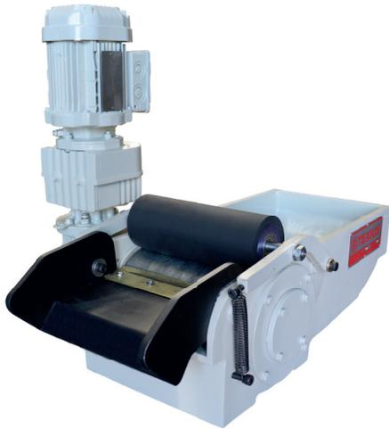
O **Separador Magnético Texius** remove grande parte das partículas metálicas provenientes do processo de usinagem. Quando instalado juntamente com o **Filtro a Gravidade Texius**, aumenta a eficiência da filtragem e diminui o uso do papel filtrante.
