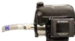
12º Passo -Recoloque a carenagem do pressurizador
